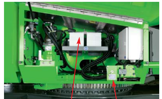
Batterie Hervorragende Zugänglichkeit zu den Batterien Battery Excellent access to the batteries
