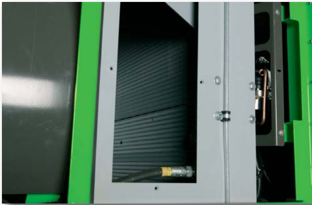
Eine Kühlbox mit 3-Kreis-Kühlsystem für Ladeluft-, Wasser- und Ölkühlung A cool box with 3-circuit cooling system for charge air, water and oil cooling
