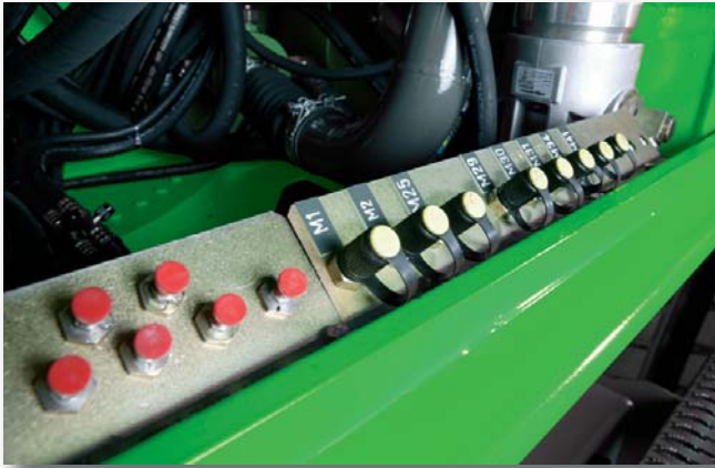
Zentrale Messpunkte zur einfachen und schnellen Überprüfung der gesamten Hydraulikanlage Central measuring points for simple and quick inspection of the entire hydraulic system
